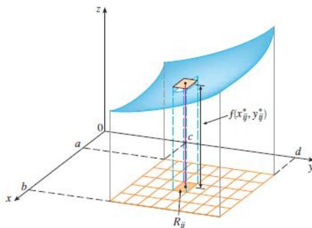
Subdividimos el intervalo  $[a, b]$  en  $m$  partes  $a = x_0 < x_1 < \dots < x_m = b$  y el intervalo  $[c, d]$  en  $n$  partes  $c = y_0 < y_1 < \dots < y_n = d$ , de modo tal que en la base de este cuerpo nos queda una cuadrícula donde cada elemento es un rectángulo de área  $\Delta A_{ij}$ .
