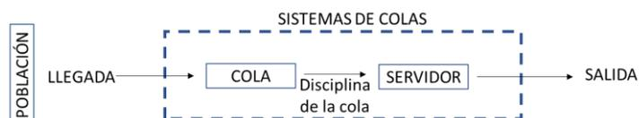
Figura 1. Representación de un sistema de una cola con un servidor
